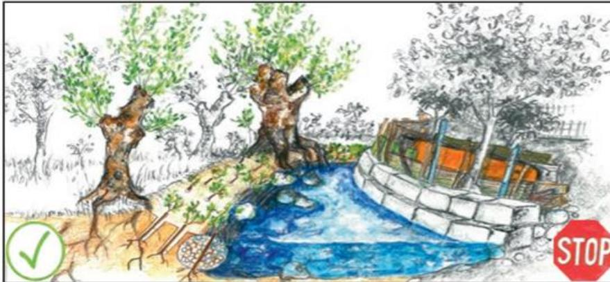
Improvisierte Ufersicherungen bieten keinen Schutz vor Hochwasser. Sie engen die Abflusskapazität ein und können durch Schwemmholz zum Verschluss von Engstellen führen.
